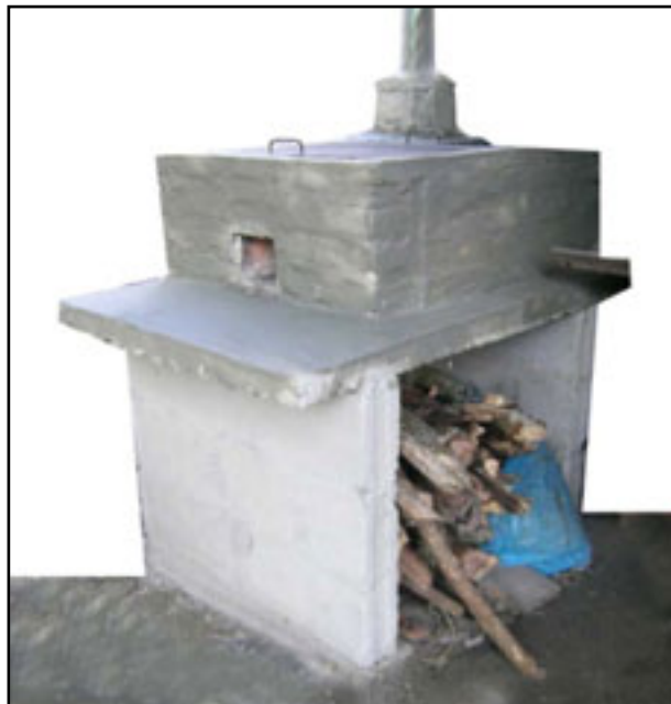
Estufa con base de bloques y plancha con cemento.
