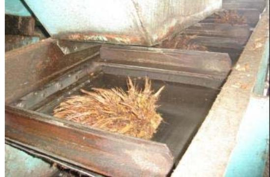
**Malaxado o Digestor.-** Se logra mediante agitación mecánica al romper las células que contienen el aceite.
