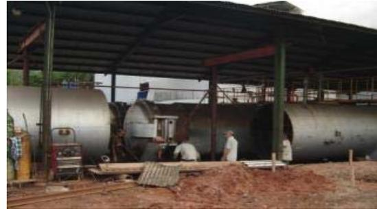
**Desgrane o Desfrutado.-** El segundo tratamiento a que se somete los RFF es la separación de los frutos (drupas) de los racimos. Esta operación se hace a través de un tambor desfrutador de unos 2 m. de diámetro, que funciona a 23 r.p.m. con un alimentador automático de racimos, que hace girar la caja con los frutos  $180^\circ$  para descargar su contenido.
